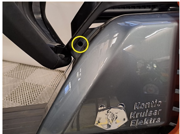
Irrota vasenta kylkipaneelia kiinni pitävä ruuvi. (ristipäämeisseli ph2).
